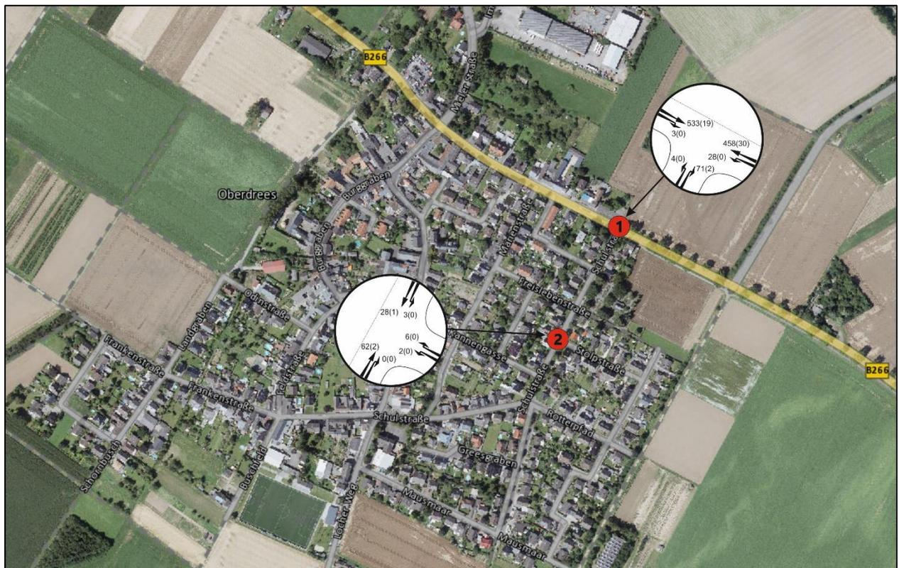
Abbildung 2: Verkehrsbelastungen während der Spitzenstunde am Vormittag (7:30 – 8:30 Uhr) [Kfz/h(SV-Kfz/h)]
