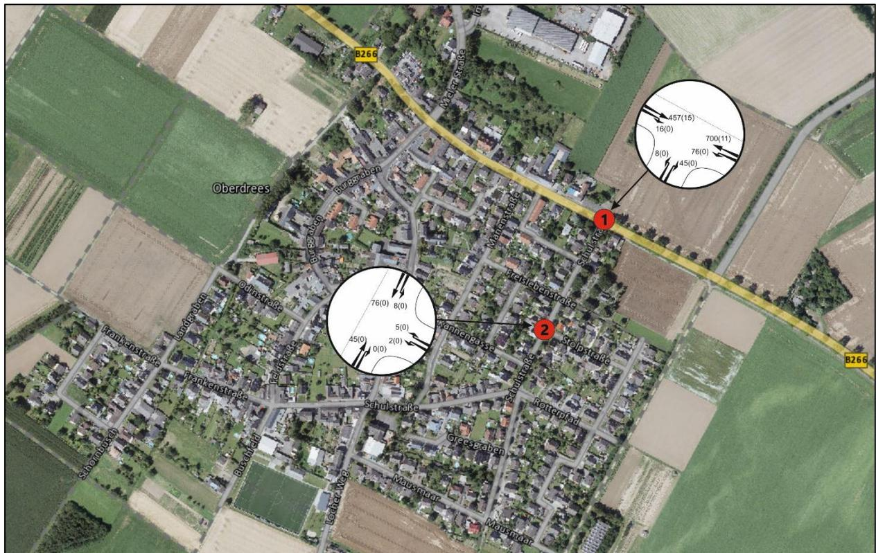
Abbildung 3: Verkehrsbelastungen während der Spitzenstunde am Nachmittag (16:30 – 17:30 Uhr) [Kfz/h(SV-Kfz/h)]
