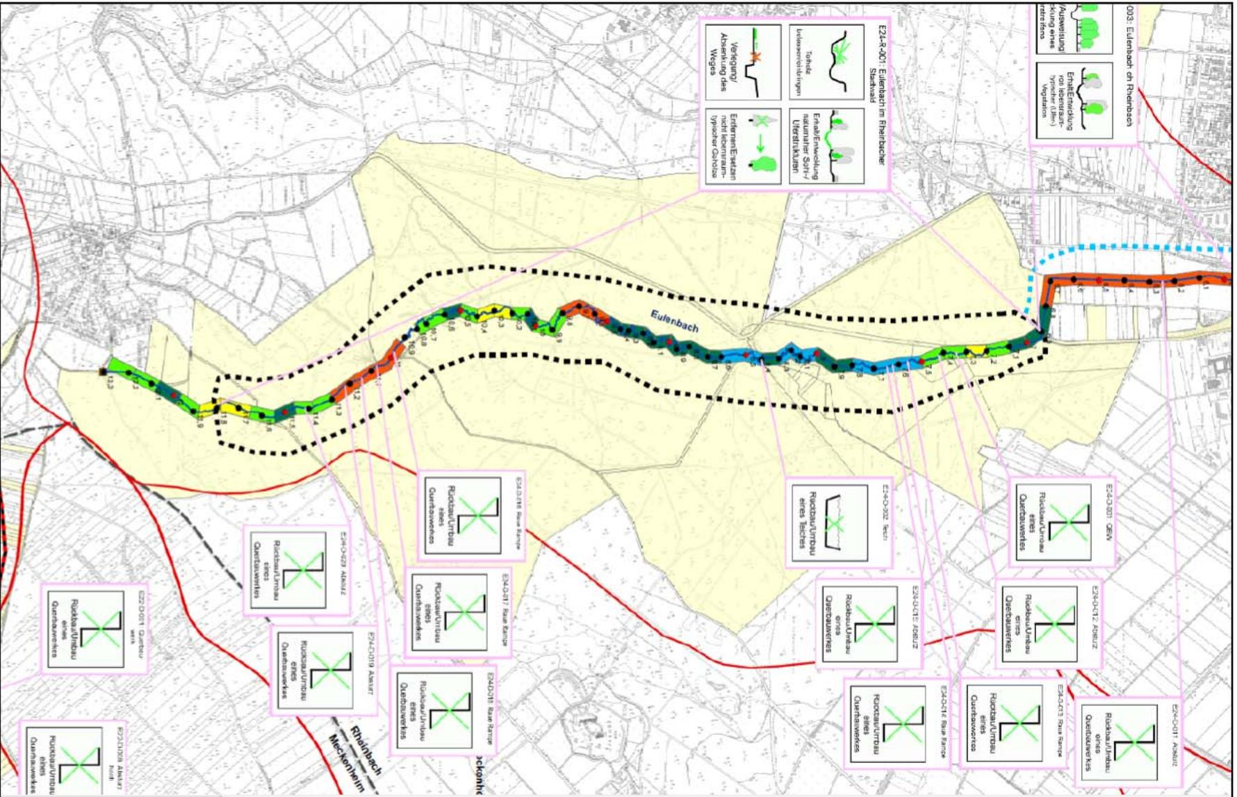
Abb. 5: Maßnahmenkarte für den Eulenbach Stat. km 6 bis Stat. km 12,3 (Quelle: UFP Eft 2012)
