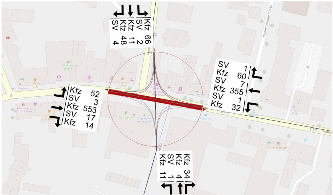
Abbildung 14: Strombelastung im untersuchten Knotenpunkt (Vergleichsfall - Morgenspitze) [Kfz/h]
