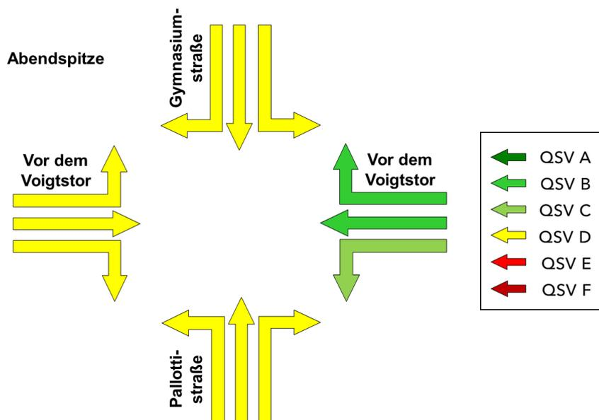
Abbildung 20: Leistungsfähigkeit der Verkehrsströme auf Basis der Optimierung
