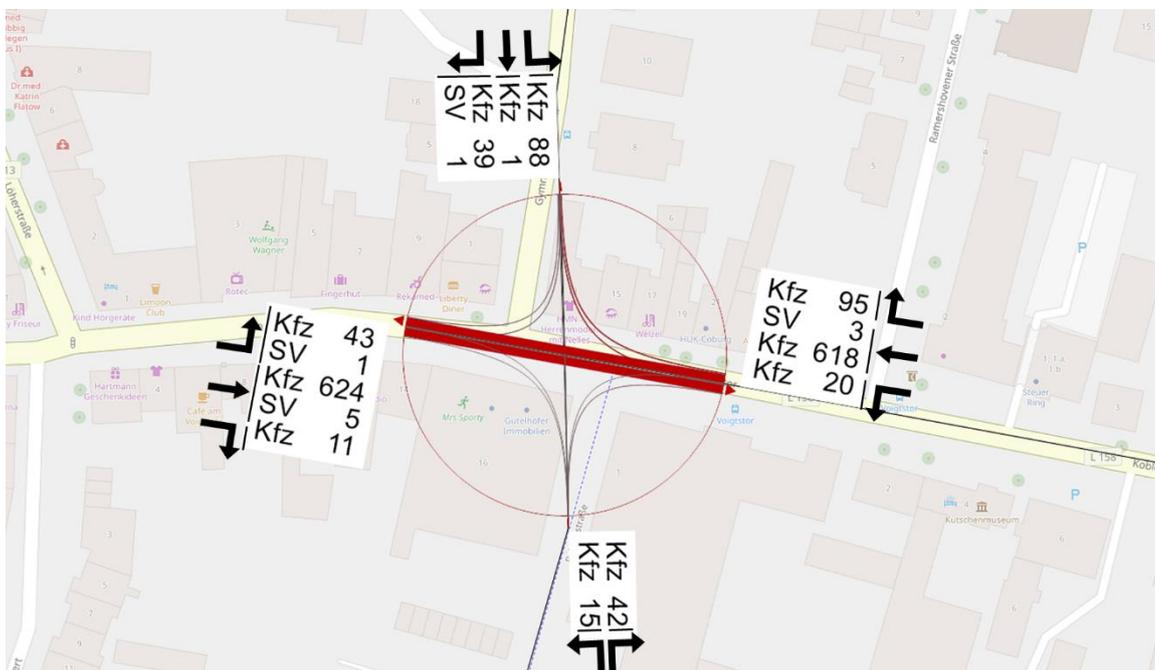
Abbildung 15: Strombelastung im untersuchten Knotenpunkt (Vergleichsfall - Abendspitze) [Kfz/h]
