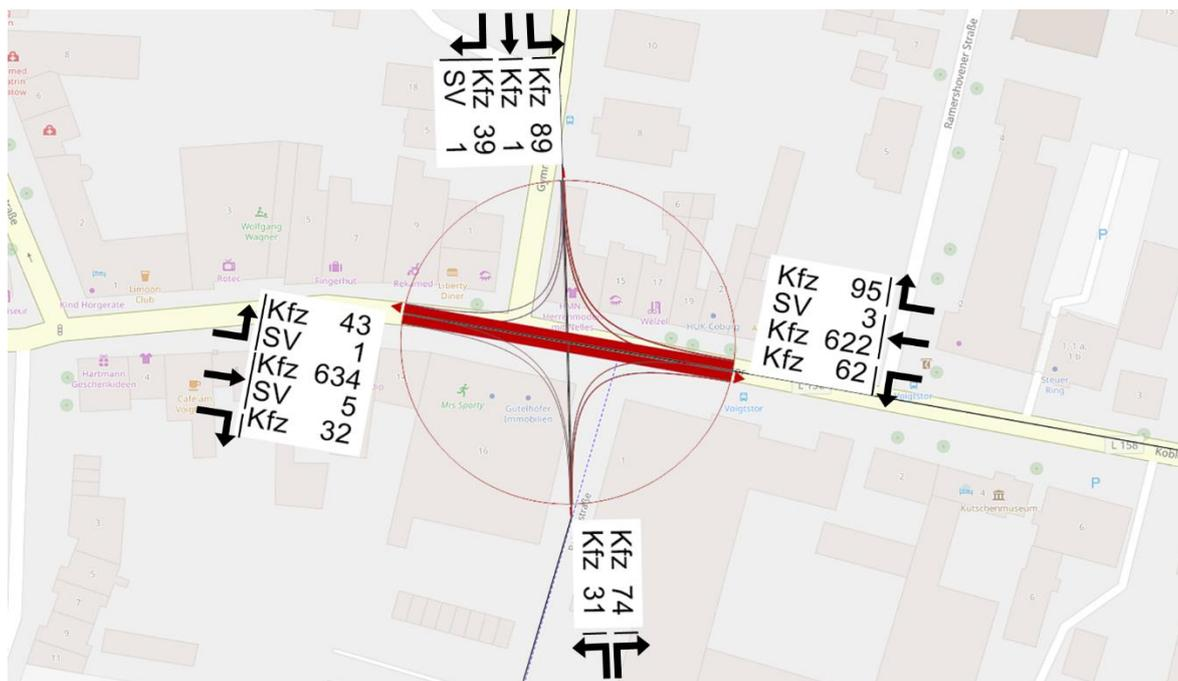
Abbildung 13: Strombelastung im untersuchten Knotenpunkt (Prognoseplanfall - Abendspitze) [Kfz/h]
