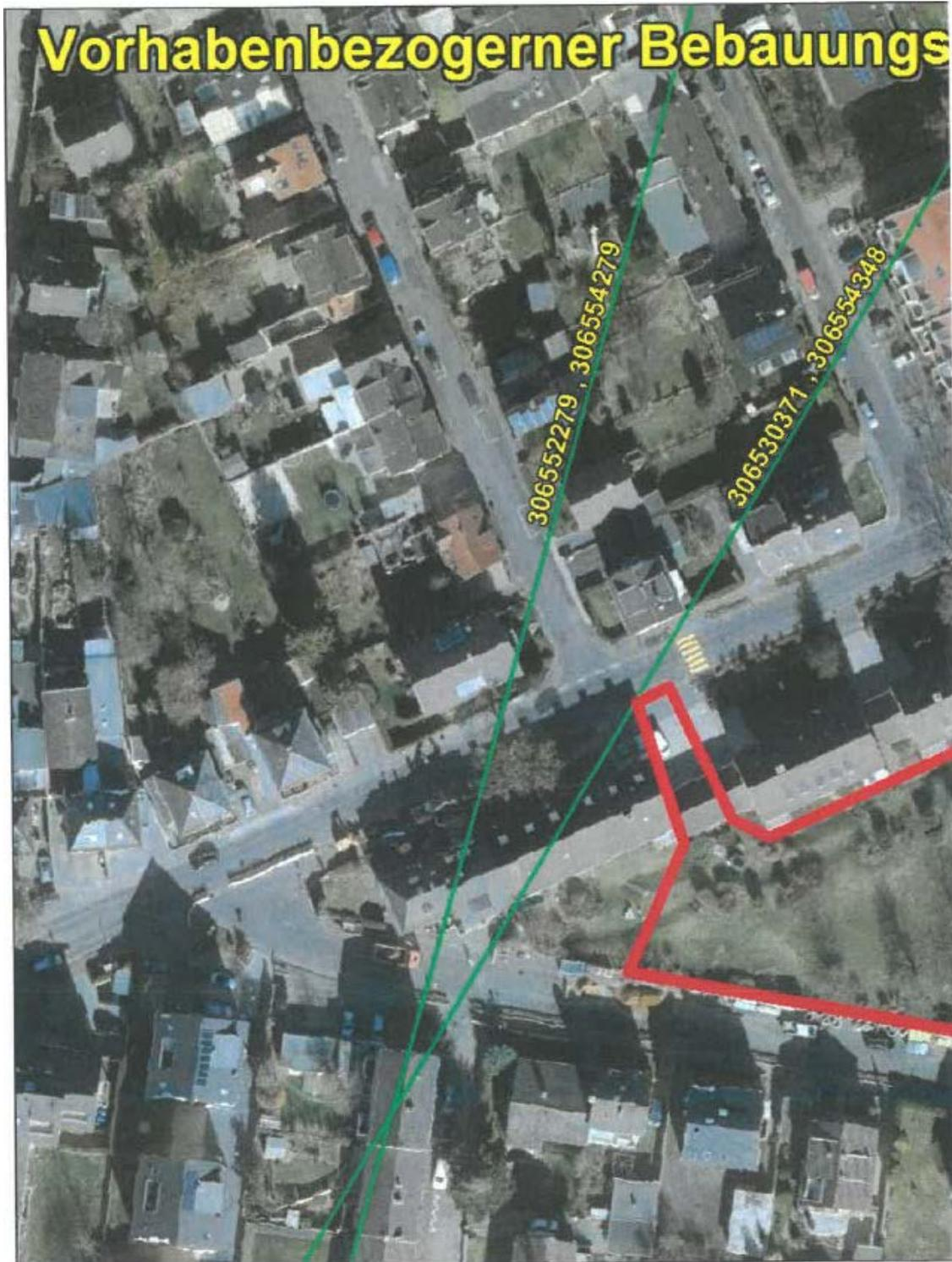
Die farbigen Linien verstehen sich als Punkt-zu-Punkt-Richtfunkverbindungen der Telefónica Germany GmbH & Co. OHG. Das Plangebiet ist im Bild mit einer dicken roten Linie eingezeichnet.
